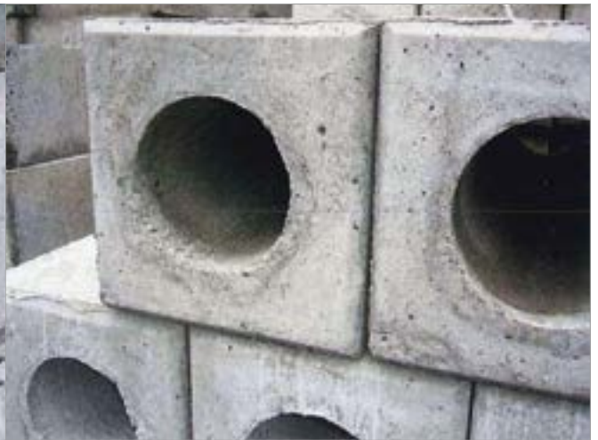
▼鉄芯で抜いた製品 ( 端部が汚い )
