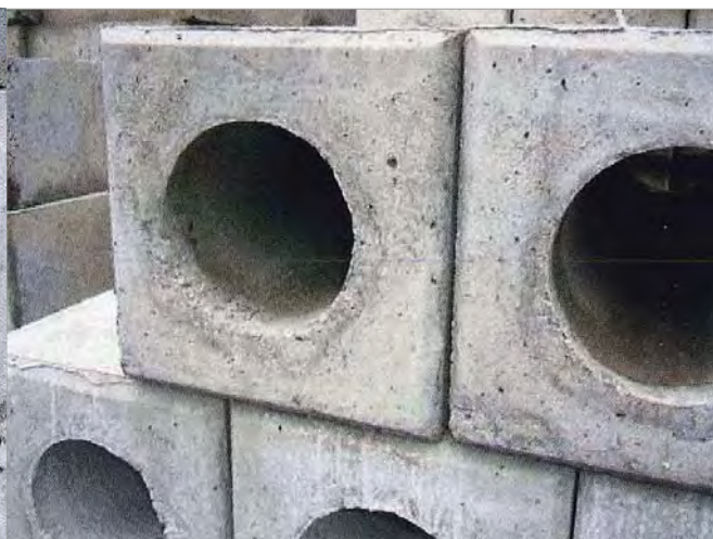
▼鉄芯で抜いた製品 ( 端部が汚い )
